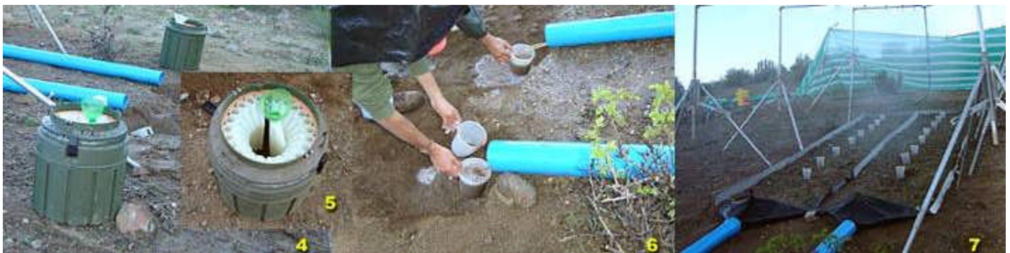
Foto 4, 5 y 6: Determinación de la escorrentía superficial y recolección de sedimentos producto del arrastre de la precipitación. Foto 7: Vista general del ensayo.
