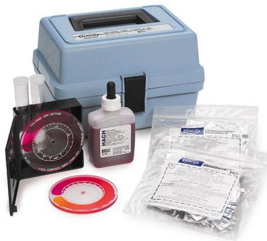
Imagen N°12: test colorimétrico para medición de cloro libre.
