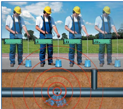
Imagen N°36: Sistema de detección de fugas por medio de geófono con tecnología DSA.
